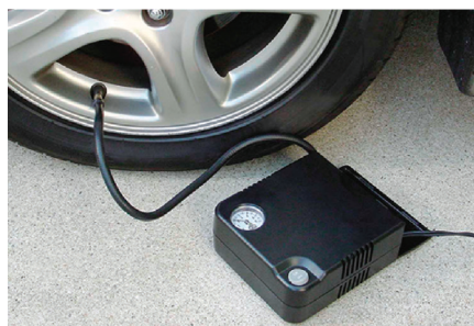
STEG 2: Fyll på med luft med luftkompressor
